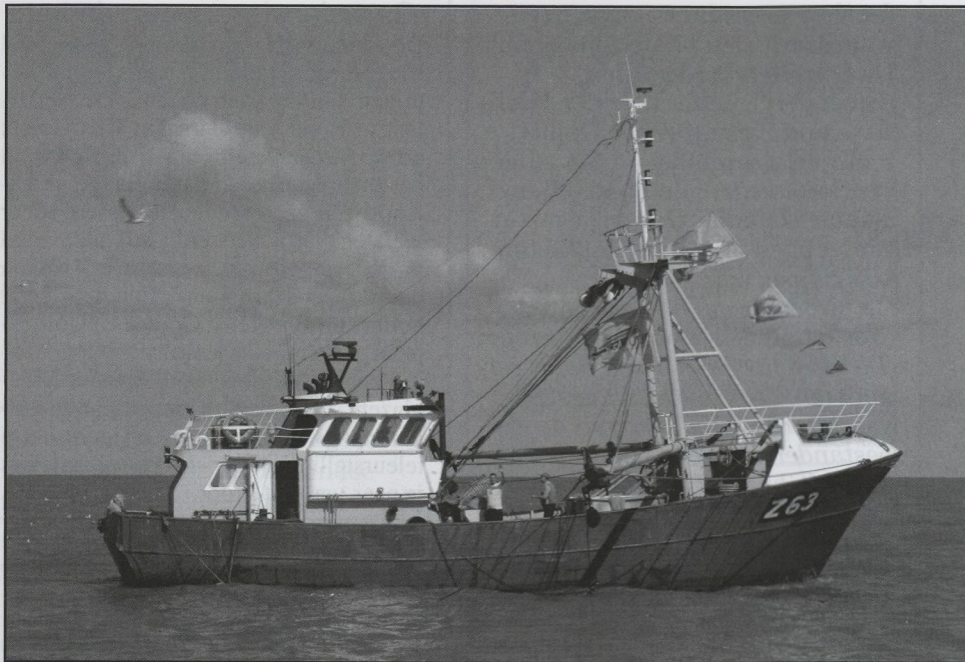
De Z 63 Thalassa (bouwjaar 1987, 20,04 meter L.O.A., nieuwe motor Cummins [2000] 219 kW, is eigendom van de rederij Moby Dick uit Heist. (foto gw)
