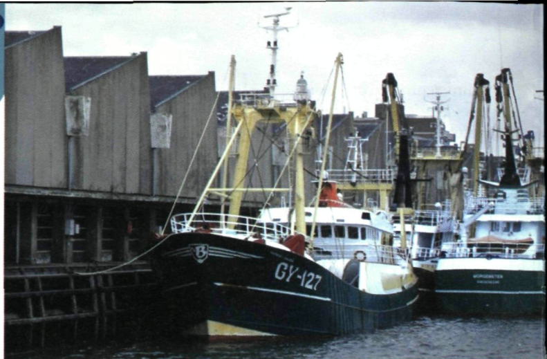
De GY 127 werd door de Ekofish Group aangekocht in 2002 en toen al geschikt gemaakt voor twinrigvisserij. Door de grootte van het schip was het geen probleem om het in 2009 ook om te bouwen voor de flyshootvisserij. Er werden extra grote lieren aan dek gezet zodat de vissers met 50 mm touw kunnen jagen i.p.v. 40 mm. De 50 mm zakt minder in de bodem en heeft dus minder effect op kleine bodemvissen.
