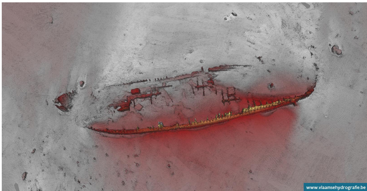
Bijlage 3: Multibeam opname van het houten scheepswrak nabij de oostelijke strekdam, haven van Oostende (114/255d) van 25/02/2019 door de Vlaamse Hydrografie, 3D zijzicht (copyright: MDK – Afdeling Kust – Vlaamse Hydrografie 2019).
