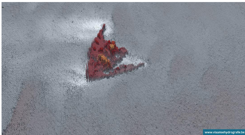
Bijlage 3: Multibeam beeld genomen op 02/12/2015 door de Vlaamse Hydrografie, 3D detail boegfragment (copyright: MDK – Afdeling Kust – Vlaamse Hydrografie 2015).
