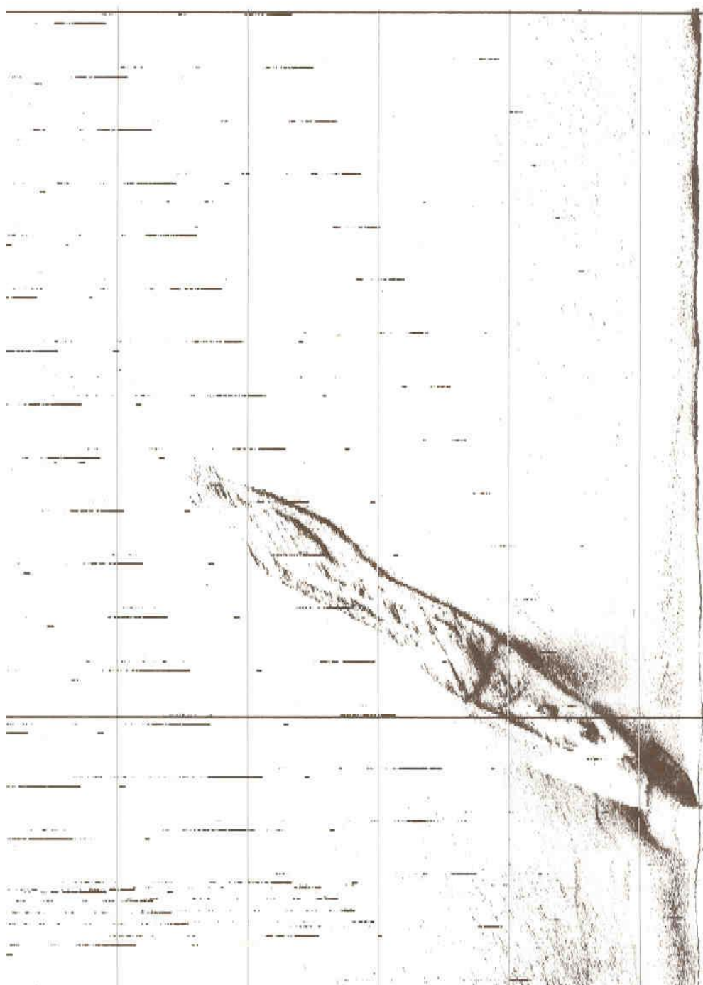
Bijlage 2: Side Scan Sonar opname van de Vorpostenboot Frigg (B126/309), uitgevoerd door de Vlaamse Hydrografie op 08/04/1993 (copyright: MDK-Afdeling Kust-Vlaamse Hydrografie 1993).
