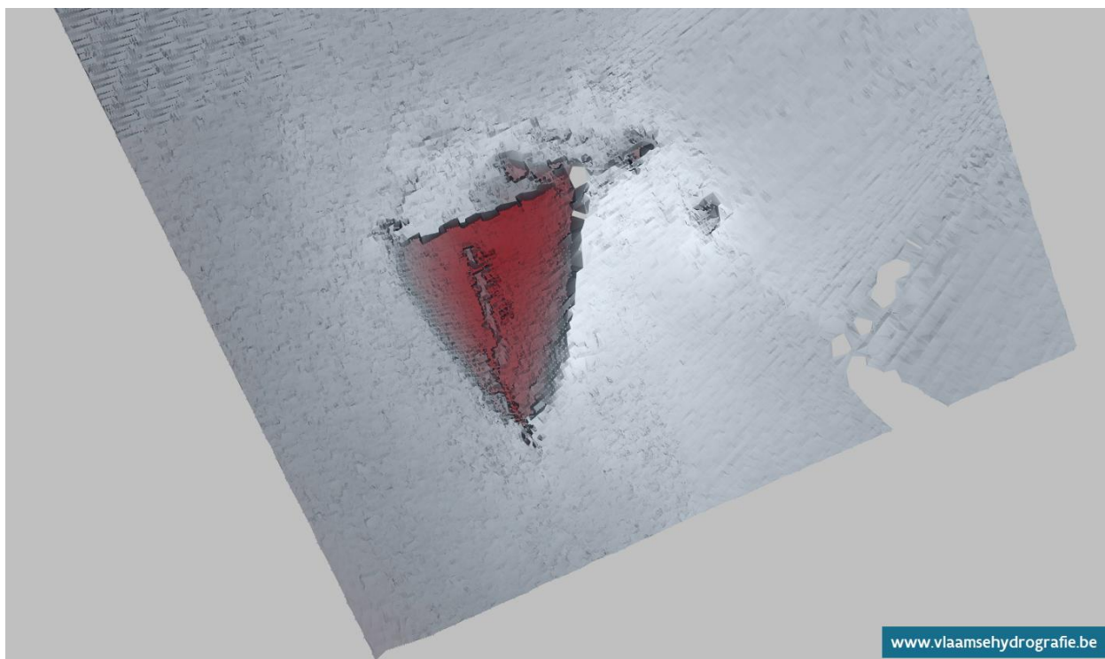
Bijlage 2: Multibeam opname van de B114/256 door Vlaamse Hydrografie op 02/12/2015, 3D bovenzicht vermoedelijke boegdeel (copyright: MDK – Afdeling Kust – Vlaamse Hydrografie 2015).
