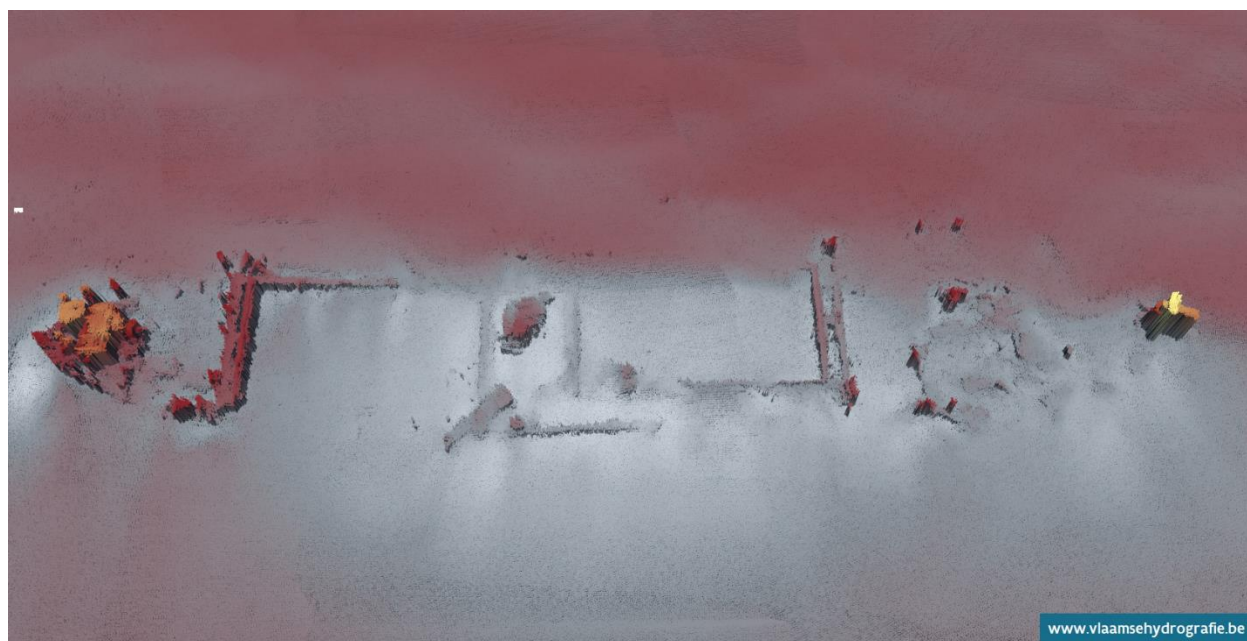
Bijlage 2: Multibeam opname van de B108/237 (CMB-71A) genomen door Vlaamse Hydrografie op 24/07/2018, 3D zijaanzicht (copyright: MDK – Afdeling Kust – Vlaamse Hydrografie).
