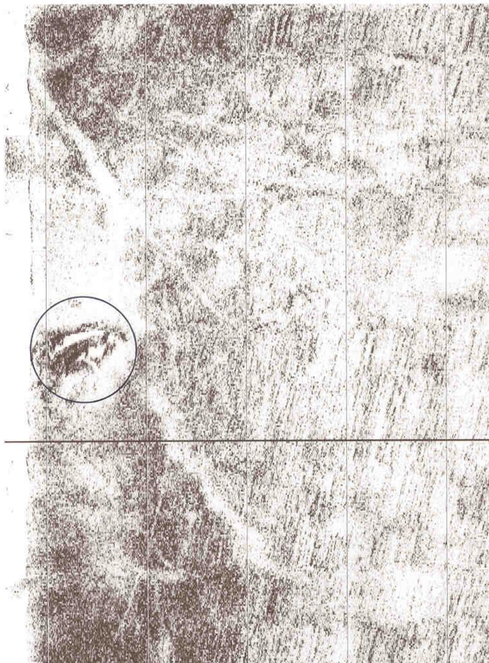
Bijlage 2: Side scan sonarbeelden van het voorschip van de G-88 (B127/304b) genomen in 03/07/1996 door de Vlaamse Hydrografie (copyright: MDK – Afdeling Kust – Vlaamse Hydrografie 1996).
