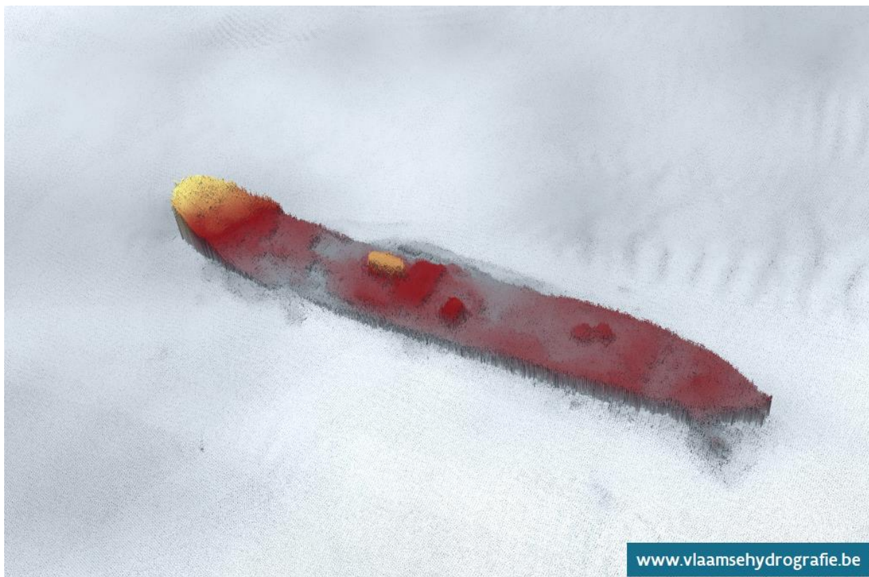
Bijlage 4: Multibeam van de SS Kilmore (B123/229) genomen op 03/04/2017 door Vlaamse Hydrografie, bovenaanzicht (bron: wrakkendatabank, copyright: MDK-Afdeling Kust-Vlaamse Hydrografie 2017).
