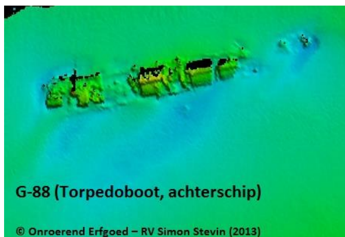
Bijlage 1: Multibeam van het achterschip van de G-88 (B127/304a) genomen op 06/08/2013 door RCMG op de RV Simon Stevin voor Onroerend Erfgoed (bewerkt door M. T’Jampens VLIZ) (copyright: RCMG, Onroerend Erfgoed).
