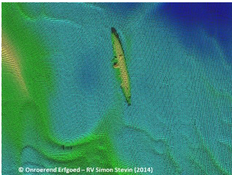
Bijlage 1: 2D multibeam opname van de UB29 (B122/237) genomen door Onroerend Erfgoed op de RV Simon Stevin op 10/04/2014 (bewerkt door Koen Degrendele, FOD Economie) (copyright: Onroerend Erfgoed – RV Simon Stevin 2014).
