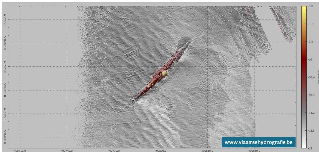
Bijlage 3: Multibeam opname van de U-11 (B120/252), zuidwest-noordoost gericht in de bredere omgeving, genomen op 20/04/2018 door de Vlaamse Hydrografie (3D beeld) (copyright: MDK – Afdeling Kust – Vlaamse Hydrografie 2018).
