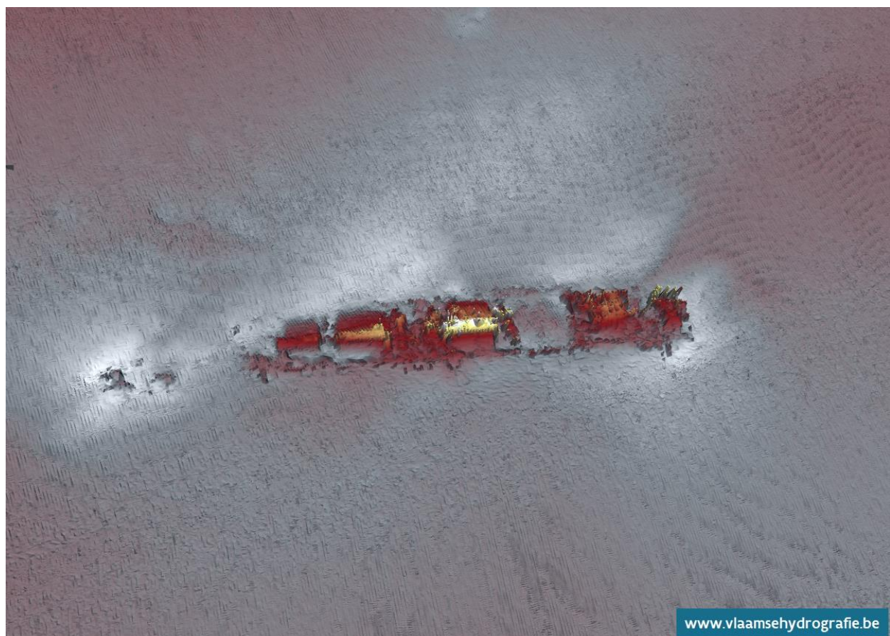
Bijlage 4: Multibeam van het achterschip van de G-88 (B127/304a) genomen op 15/09/2014 door de Vlaamse Hydrografie, 3D zijaanzicht (copyright: MDK – Afdeling Kust – Vlaamse Hydrografie 2014).
