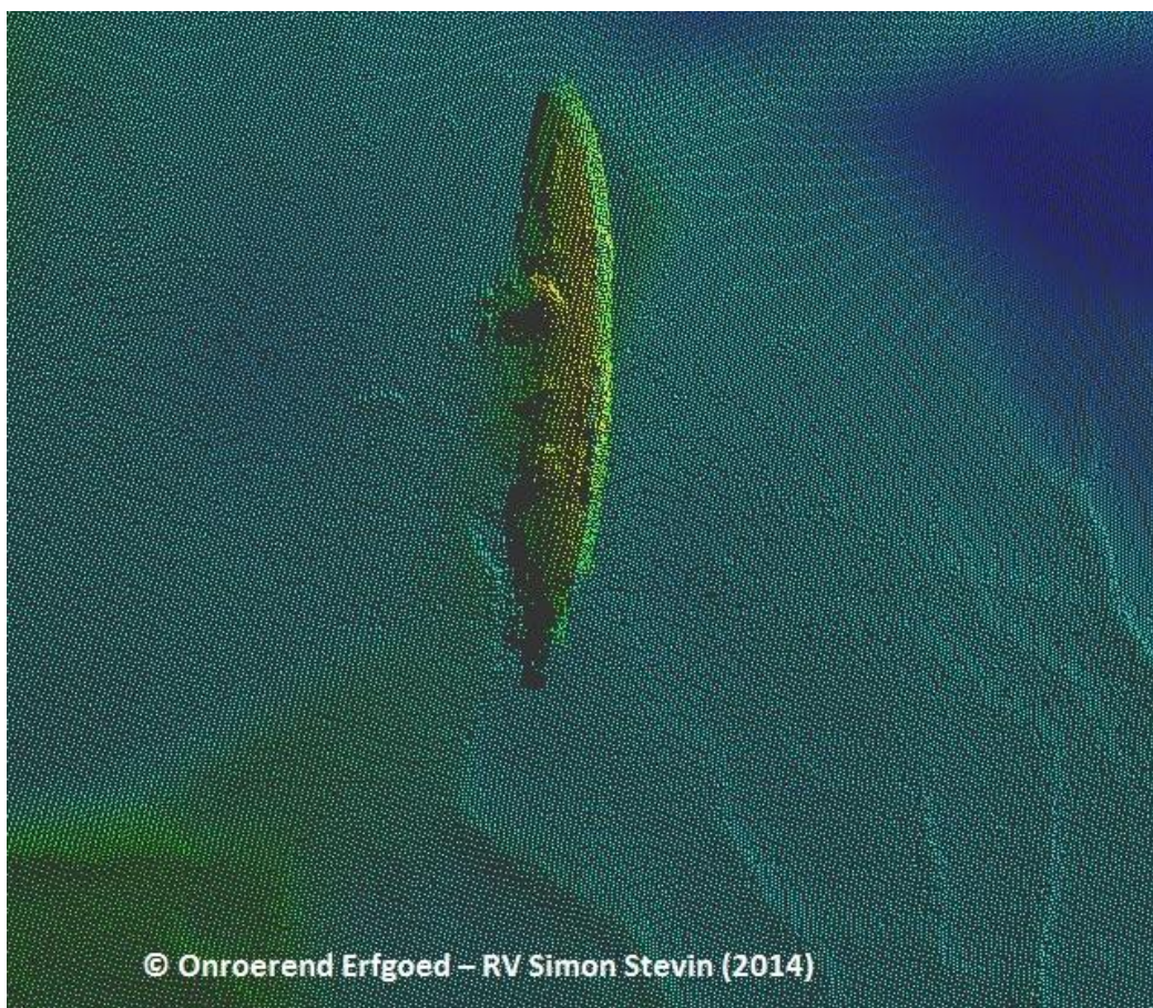
Bijlage 2: 3D multibeam opname van de UB29 (B122/237) genomen door Onroerend Erfgoed op de RV Simon Stevin op 10/04/2014 (bewerkt door Koen Degrendele, FOD Economie) (copyright: Onroerend Erfgoed – RV Simon Stevin 2014).
