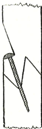
Fig. 10. Assemblage du bordé des navires de la côte de Gujarat (d'après J. HORNELL, The Mariner's Mirror , 16, 1930, p. 311, fig. 1 et F. PARIS, Essai sur la construction navale des peuples extra-européens (1841) pl. 10, fig. 4).
