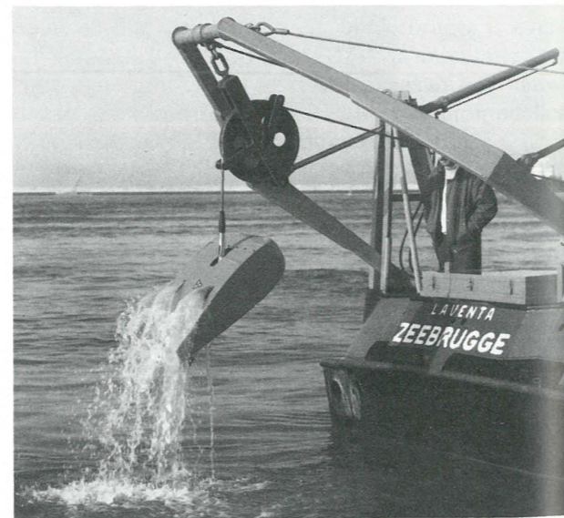
Foto 6. — De nieuw ontwikkelde continu werkende dichtheitssonde „Navitracker”.
