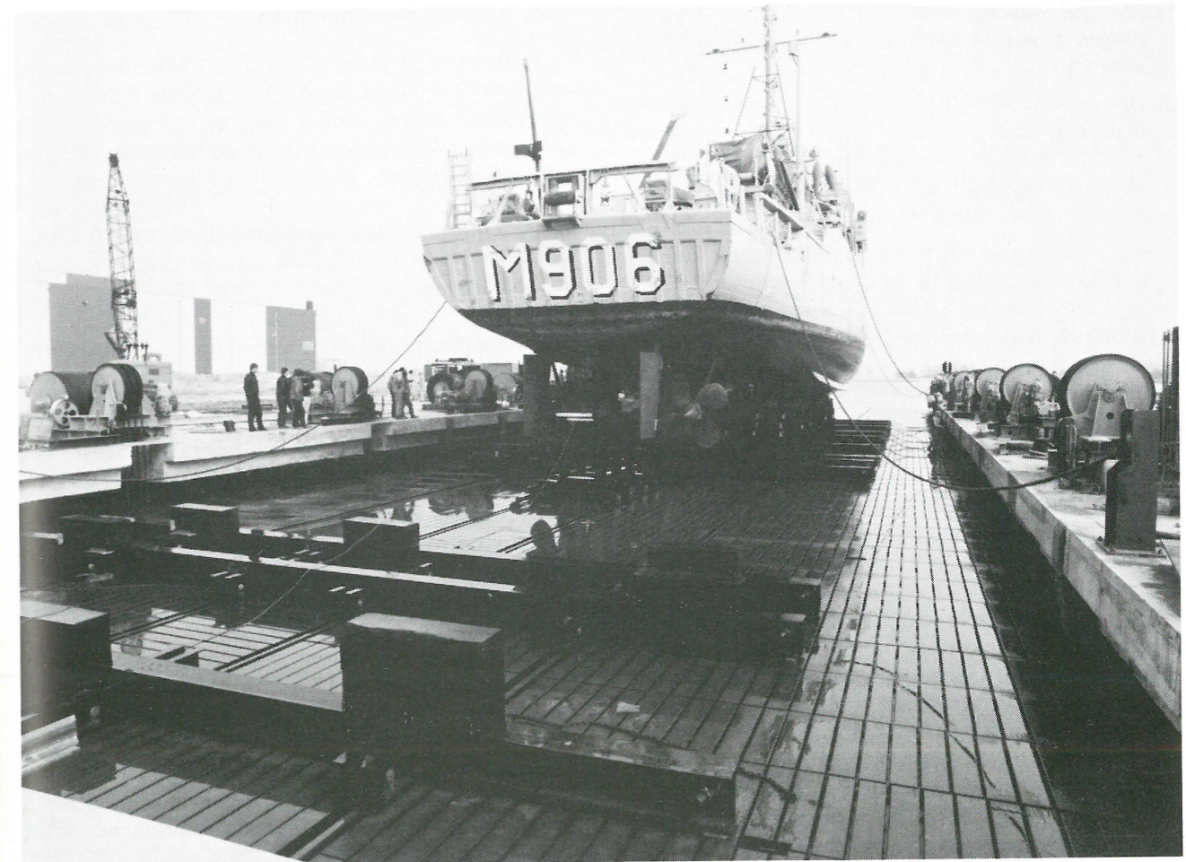
Liftplatform tijdens de droogzetting van een schip.
