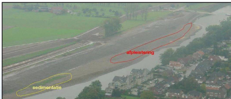
Figuur 5. De nieuw aangelegde grindbank te Meeswijk, met aanduiding van de zones waar na een eerste winter sedimentatie en erosie (afpleistering) is opgetreden.
