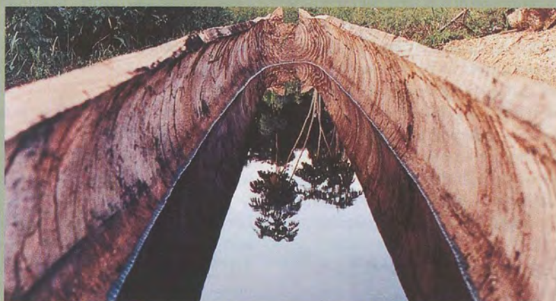
Première étape de la construction d'une pirogue : le tronc est évidé d'une manière parfaitement régulière, à l'aide de haches et de graminettes. L'extérieur est ensuite équarri.
