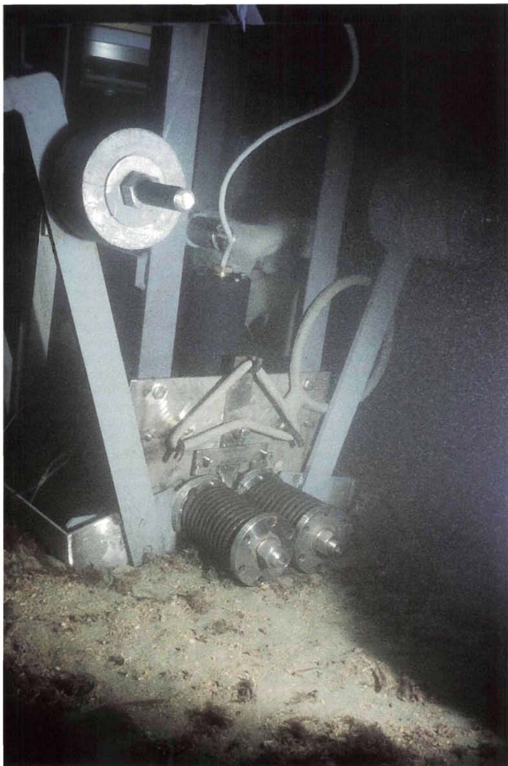
Figure 15 - Prélèvement de sédiments par carottage pour l'étude du benthos.
