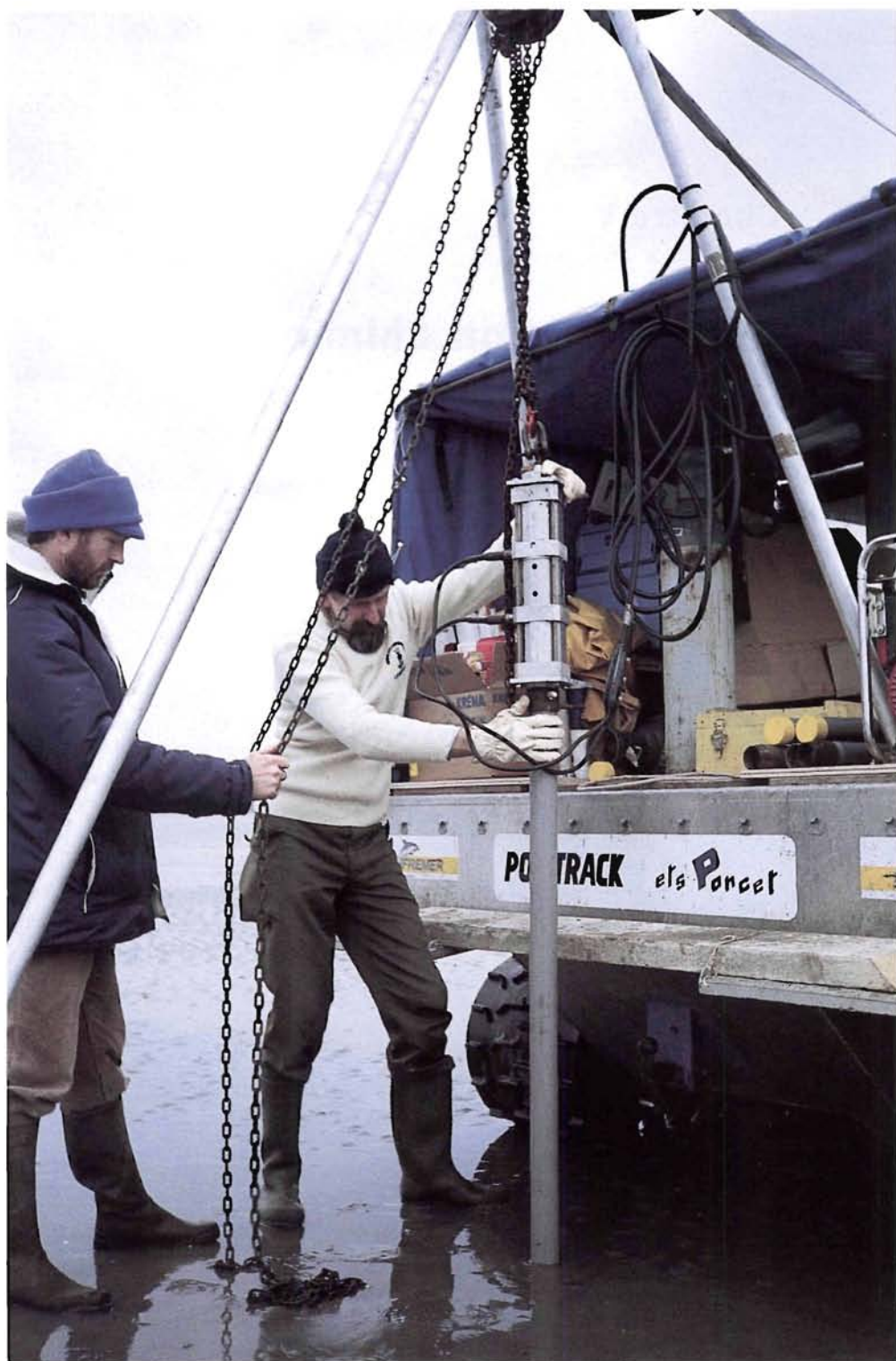
Carottage de sédiments sur l'estran pour l'analyse de contaminants.
