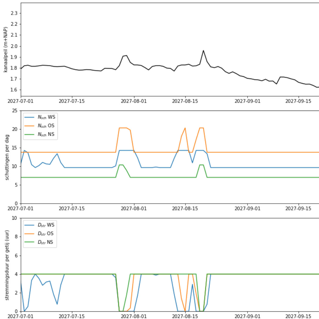
Figuur 3-15: Voorbeeld van het berekende kanaalpeil (boven), het aantal schuttingen per dag (midden) en de stremmingsduur per getijperiode (onder) voor schutstrategie S3 bij combinatie met de bovenafvoer in de derde zomer uit afvoerscenario Q2.
