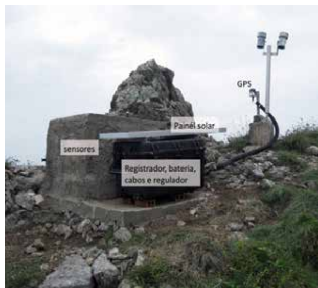
Figura 1. Representação dos equipamentos que formam a estação sismográfica.
