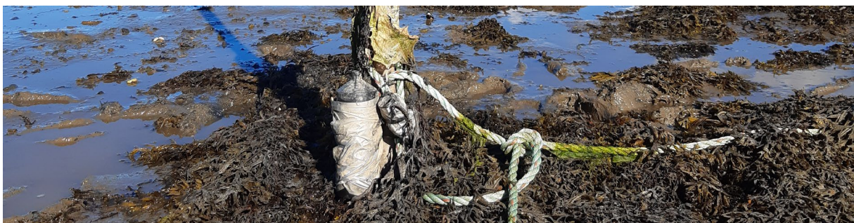
Bilde 1. Lyttestasjon montert på påle i tidevannspåvirket område ved Råbygd fjæra. Foto: Jan Grimsrud Davidsen
