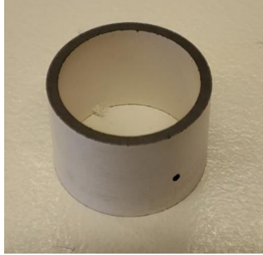
Figura 8. Piezoelèctric utilitzat com a transductor acústic en aquest treball
