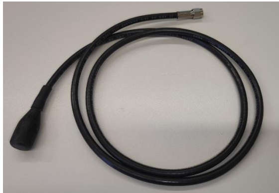
Figura 9. Encapsulat i cablejat del transductor piezoelèctric
