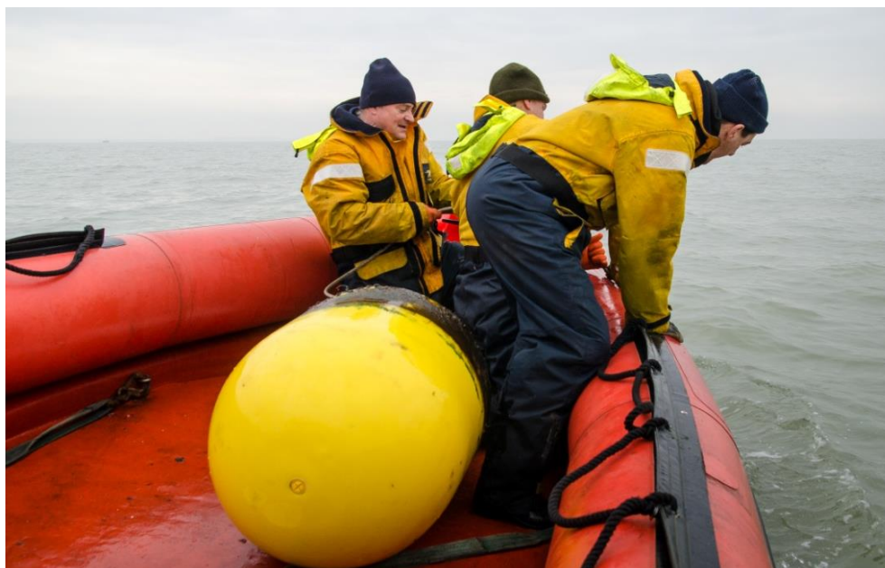
Figuur 4.1: De RHIB van de RV Belgica pikt de oppervlakteboei van de tripode op waaraan het ophaaltouw is bevestigd. (photo genomen door J. Urbain - Belgische Marine)
