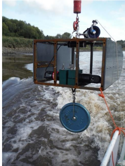
Figuur 2.13: De LISST-200X van Sequoia bevestigd in een meetframe die uitgerust is met stroomgeleiders
