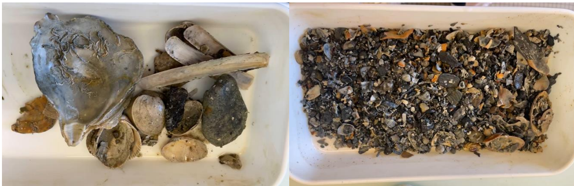
Figure 3 : Photos des refus de tamis
