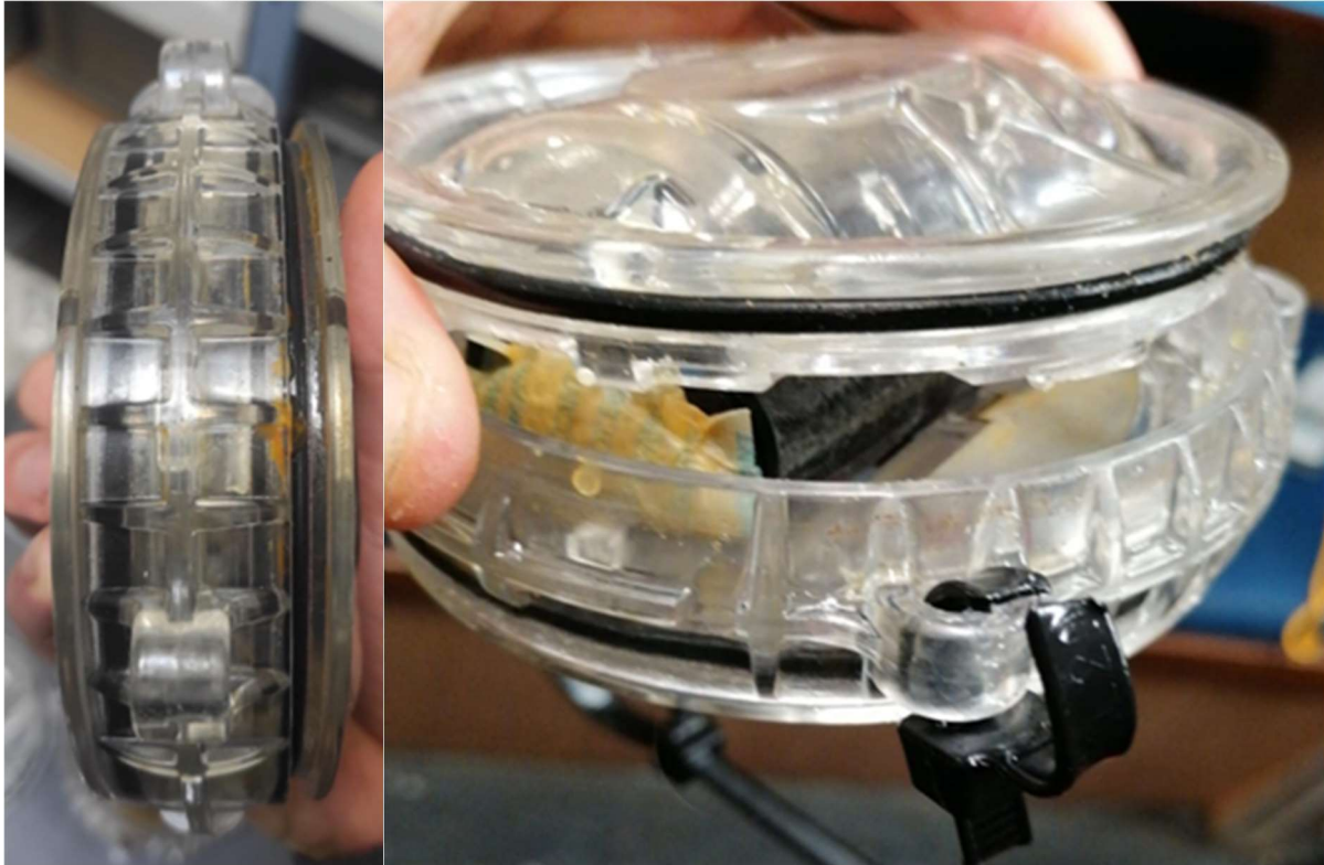
Figuur 8 - Twee gebroken Pisces lampen. In de linkse afbeelding is een van de helften uit de ring geschoten. Op de rechtse afbeelding is de hele ring los.
