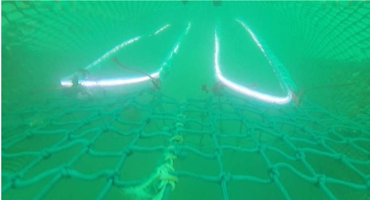
Figuur 5 - Foto van de tweede opstelling aan boord van de RV Simon Stevin. Het beeld is genomen van achter naar voren in het net. De LED-scheidingspanelen hangen onder een schuine hoek, bevestigd aan het BRP met bungeekoord. De onderkant van de foto toont het BRP. Op het moment van opname was het net nog aan het afdalen in de waterkolom. Merk het trekken aan het net op.
