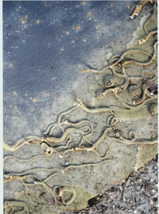
Aangroei van trompetkalkkokerwormen op het roer van een boot uit het Veerse Meer.
