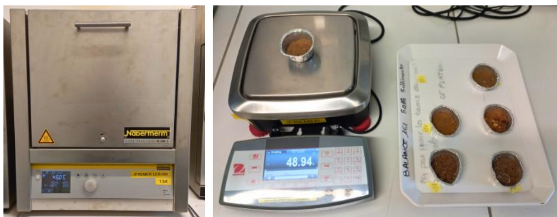
Figure 5 : Four à moufle Nabertherm et pesée des sédiments calcinés.
