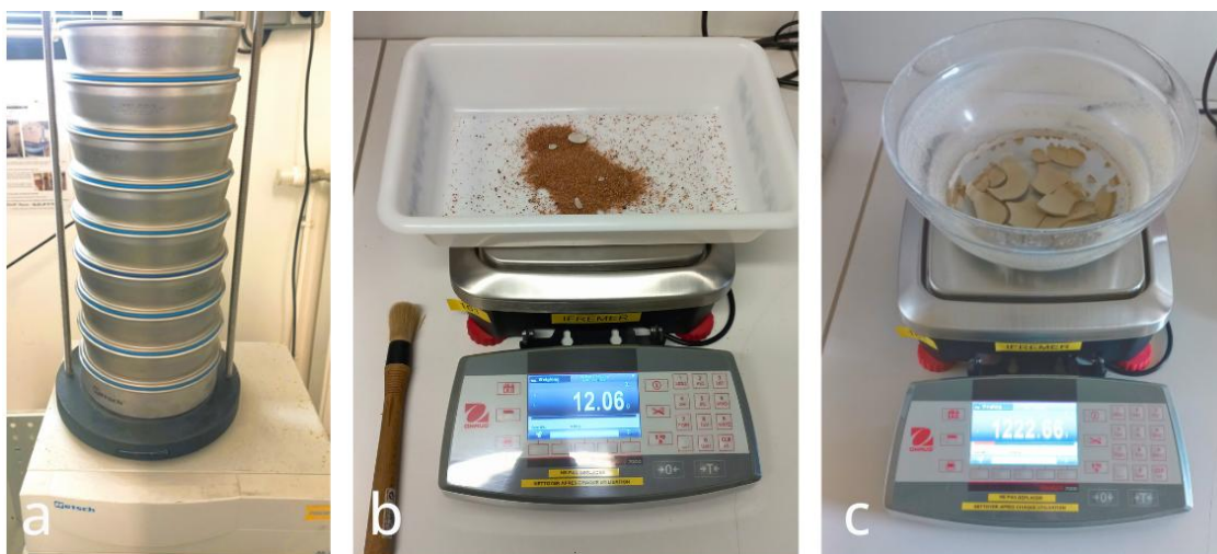
Figure 4 : (a) : Tamisage des sédiments avec colonne de tamis sur tamiseuse Retsch AS 200. (b) : Pesée des fractions de sédiments grossiers de chaque tamis. (c) : Pesée de la fraction fine sèche.
