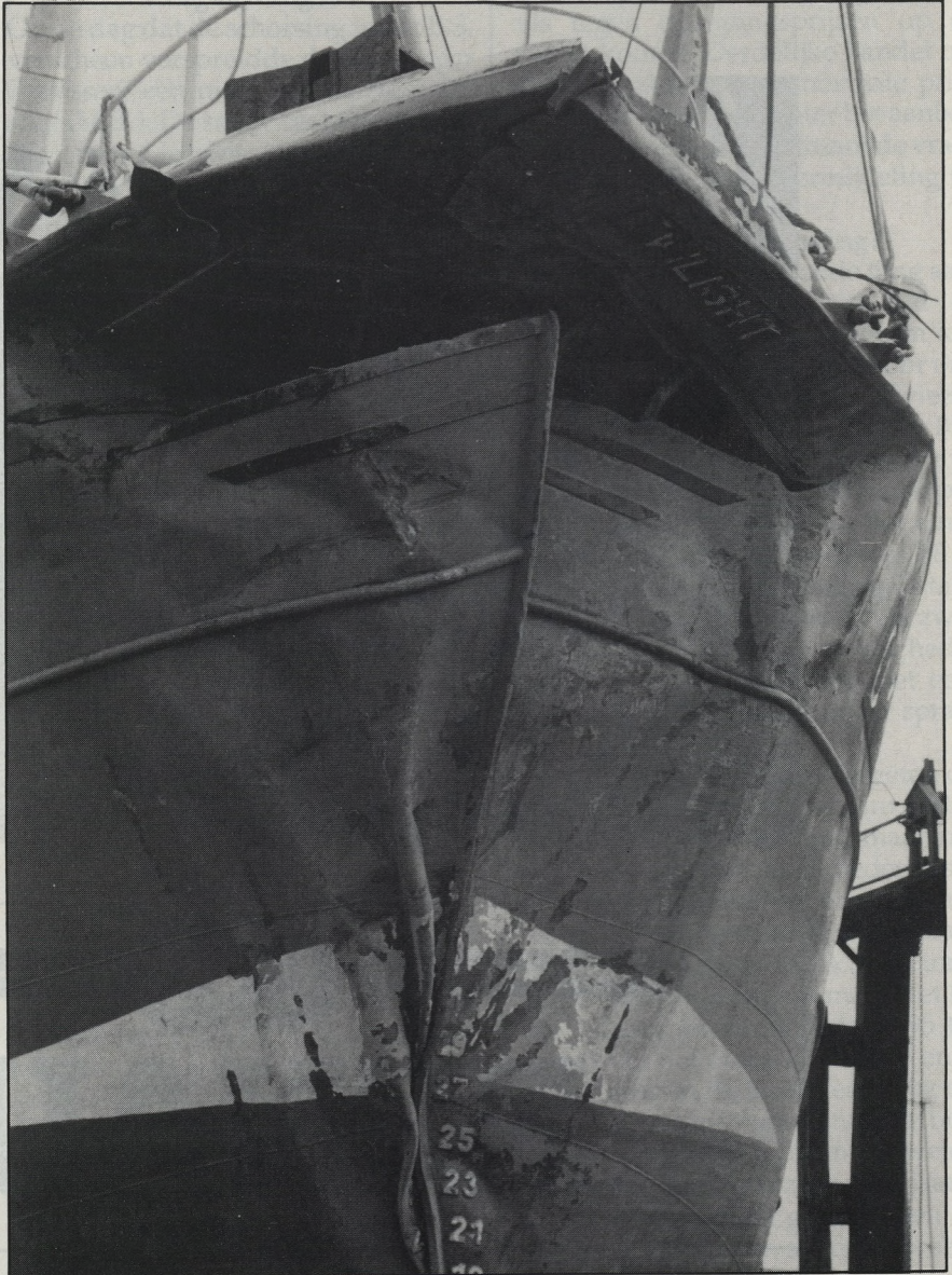
De zwaargehavende steven van de O.137 Twilight na de aanvaring met de palmolietanker. (Foto gw)
