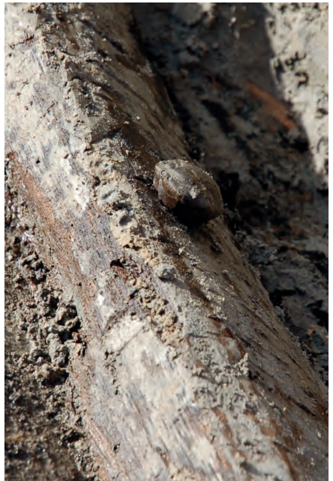
Afb. 17 Een houten pen met bolle kop. Deze steekt uit het liggende deel van een kromhout in het voorschip. Foto RCE.
