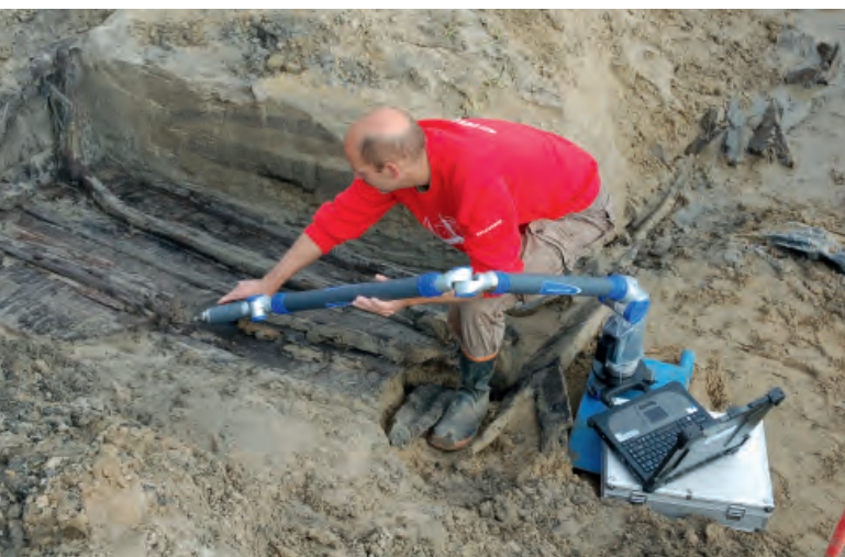
Afb. 3 De vrij gelegde delen van het wrak zijn in 3D vastgelegd met de digitale tekenarm (Faro Arm). Foto RCE.
