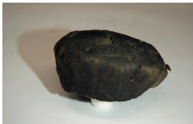
Afb. 18 Detail van de bolle kop van een 'Noordse pen'. Foto's RCE.
