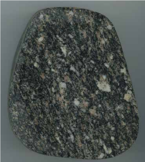
Afb. 38 Scan van zaagvlak van vondst NZN19 8, waarin duidelijk een richting is waar te nemen in de donkere delen. Ook zijn grote veldspaten (roze) en uitgegroeide kwartskristallen zichtbaar (wit). Hoogte van de steen is 10 cm.
