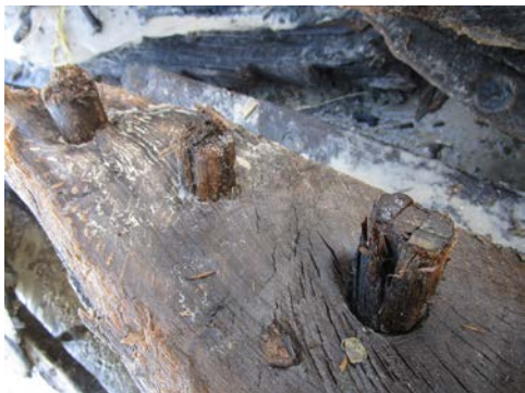
Afb. 5.30 Houten pennen met wiggen in een inhout, diameter pennen circa 3 tot 3,5 cm (foto: N. Brinck, Terschelling).
