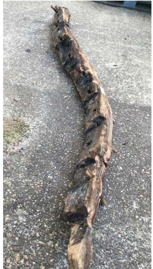
Afb. 5.28 Inhout vnr V9/S10, waarbij het bovenste deel glad is afgewerkt en in het onderste deel zeven inkepingen voor een overnaadse huid zijn aangebracht. Ook is de S-vorm van het inhout goed te zien.
