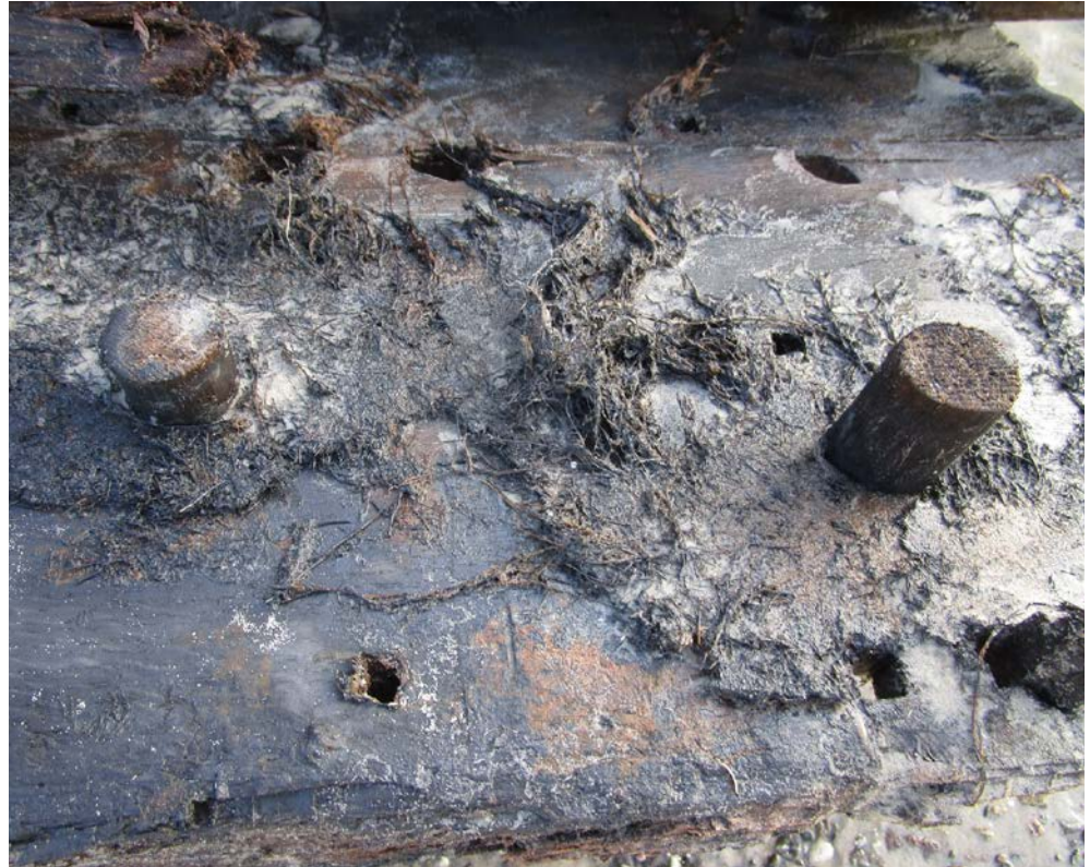
Afb. 5.34 Plakkaat breeuwmateriaal op een overnaadse las van vnr V17-A (gang G1) (foto: N. Brinck, Terschelling).
