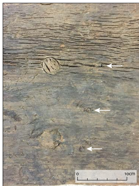
Afb. 6.6 Drie spijkerpennen in een huidplank van het Koperplatenwrak (foto: Van den Brenk & Overmeer 2019).
