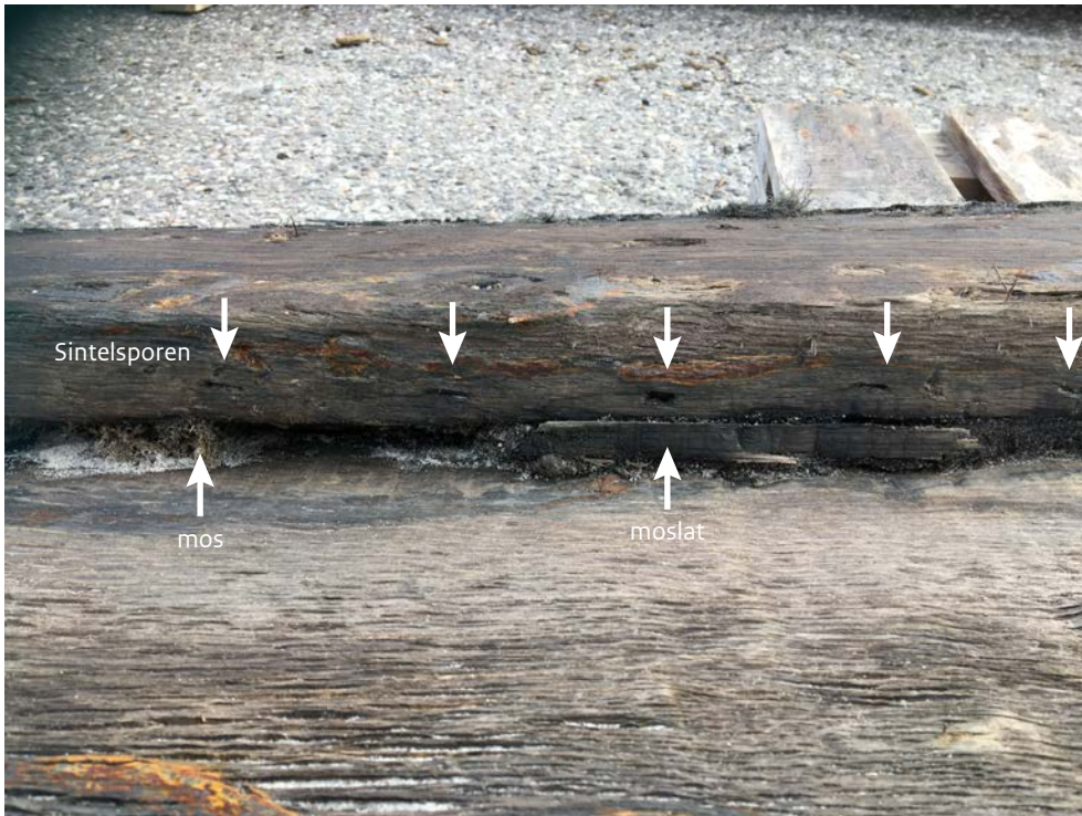
Afb. 5.33 Sintelsporen in de rand van vnr V11-A, met daaronder de resten van breeuwsel en een moslat (tussen gangen GF en GG).
