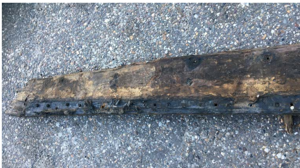
Afb. 5.19 Gelige substanties op huidplank vnr V13, mogelijk harpuijs.
