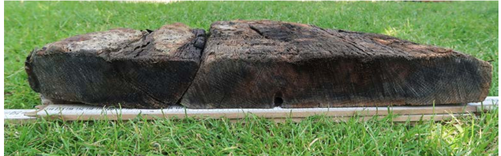
Afb. 5.16 Zaagsnede van de bemonsterde overnaadse plank vnr V12-C. Het is goed te zien dat de plank dosse (tangenciaal) is gezaagd. De kern van het hout (hier aan de bovenkant) was gericht naar de buitenzijde van het schip.
