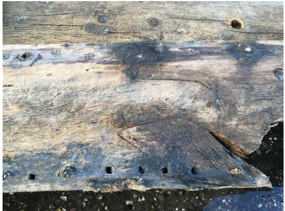
Afb. 5.17 Ingezet reparatieplankje in huidplank vnr V11-B2, circa 20 x 10 cm.
