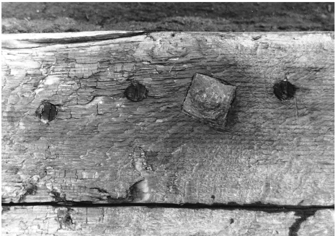
Afb. 6.5 De combinatie van klinknagels en houten pennetjes in de overnaadse huid van scheepswrak OU34 (foto: L. van Dijk (RIJP), archief maritieme archeologische rijkscollectie bij Batavialand).
