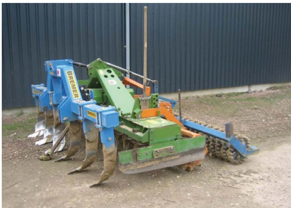
Afb. 2.3 Vaak worden in een arbeidsgang verschillende bodembewerkingen gecombineerd zoals hier een combinatie van een voorzetwoeler, rotorkoepel, drukrol en verkruiemelrol (bron: Reuler et al. 2014, foto 17).
