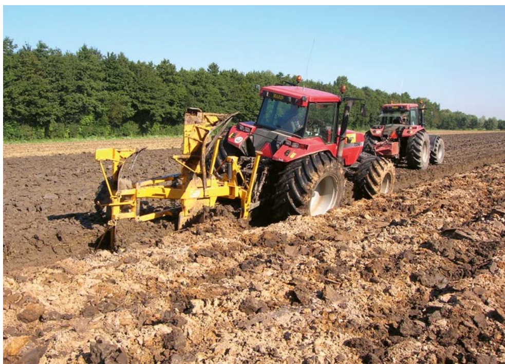
Afb. 2.6. Diepploegen tot enkele decimeters onder de bouwvoor met behulp van gekoppelde tractoren in de Flevopolder in 2004 (bron: Agrifoto). Bij zwaardere bodems en dieper ploegen worden soms ook rupsvoertuigen ingezet.
