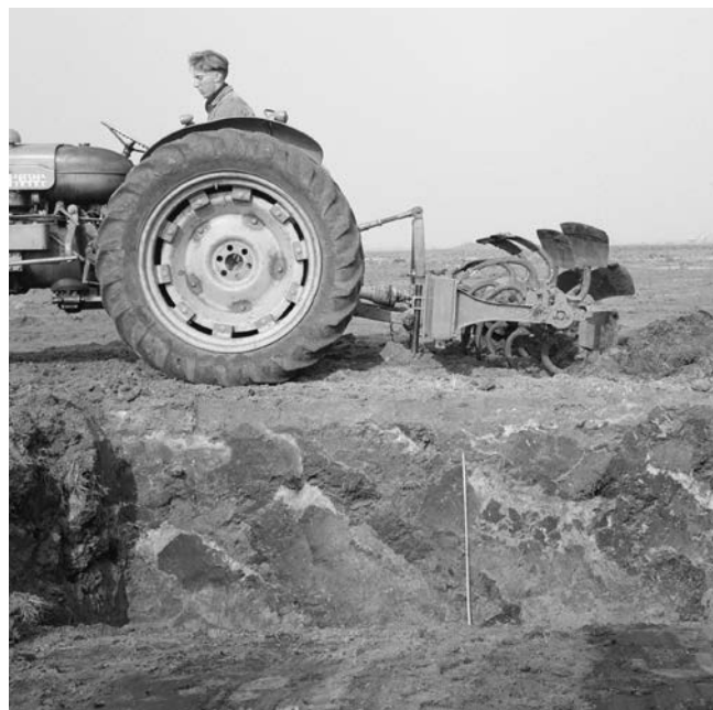
Afb. 2.10 Vriezenveen. Nabewerking met de spitmachine 1959. Op de voorgrond is het omgezette bodemprofiel te zien (bron: Nationaal Archief).
