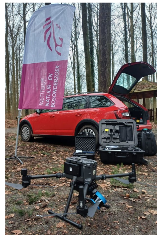
Foto's 1 en 2. Close-up van de Tsjechische drone met LiDAR-scanner (foto 1 links) die boven het bos vliegt om het te scannen (foto 2 rechts).
