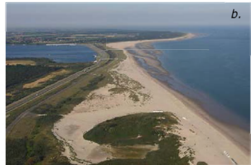
Figuur 14, a. Een voorbeeld van "Dijk in Duin" ontwikkeld door het Hoogheemraadschap van Rijnland (2007) als oplossing voor een zwakke plek in de zeewering b. De Veerse Gat dam (1961) die door transport van zand geleidelijk aan een duin is geworden.
