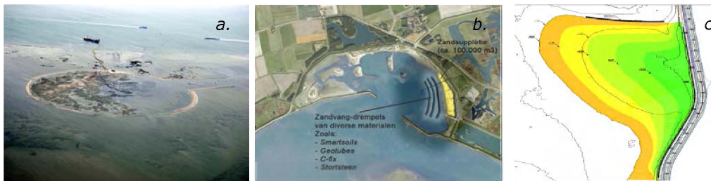
Figuur 12, a. suppletie Galgenplaat in uitvoering. b. Proef bij de Schelpenhoek waarbij het effect van drempels op het behoud van een suppletie wordt onderzocht (Tauw 2008) c. suppletie Oesterdam
