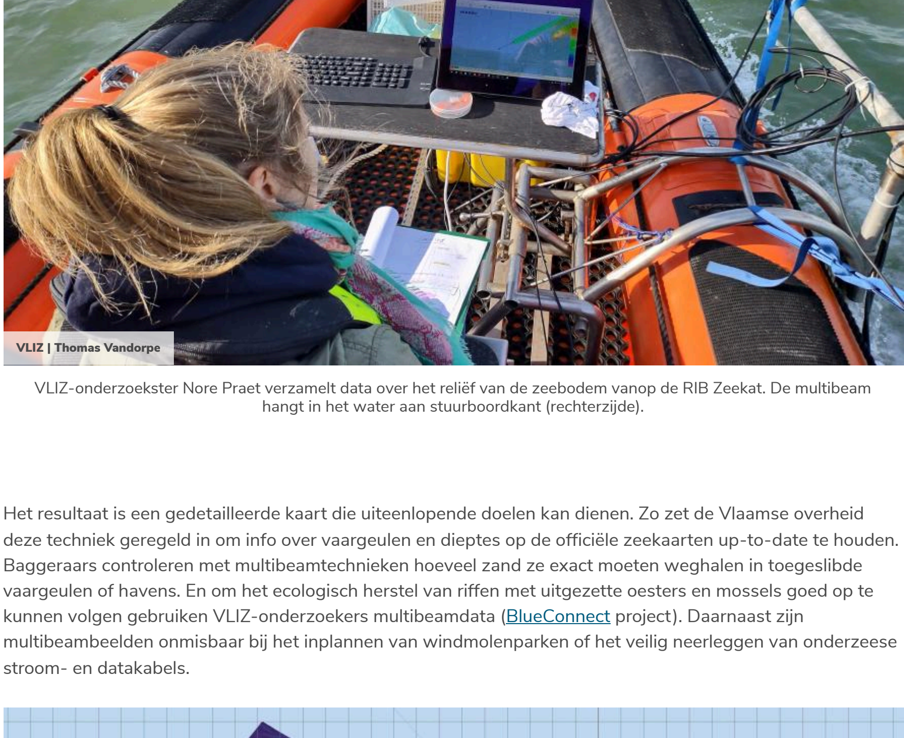
VLIZ-onderzoekster Nore Praet verzamelt data over het reliëf van de zeebodem vanop de RIB Zeekat. De multibeam hangt in het water aan stuurboordkant (rechterzijde).
