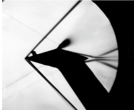
Supersone stroming van lucht (S1 windtunnel van het VKI)
