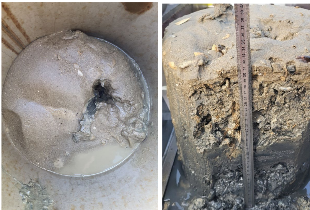
Figuur 4-16: Bodemkern van locatie 76 in de ebschaar: 2022 met D50: 44 \mu\text{m} en slib: 55% (links), 2023 met D50: 232 \mu\text{m} en slib: 5% (rechts)
