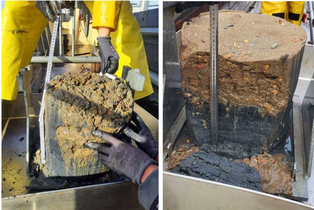
Figuur 4-14: Bodemkern van locatie 52 in de Spleet: 2022 met D_{50} : 18 \mu\text{m} en slib: 63% (links), 2023 met D_{50} : 372 \mu\text{m} en slib: 0% (rechts)
