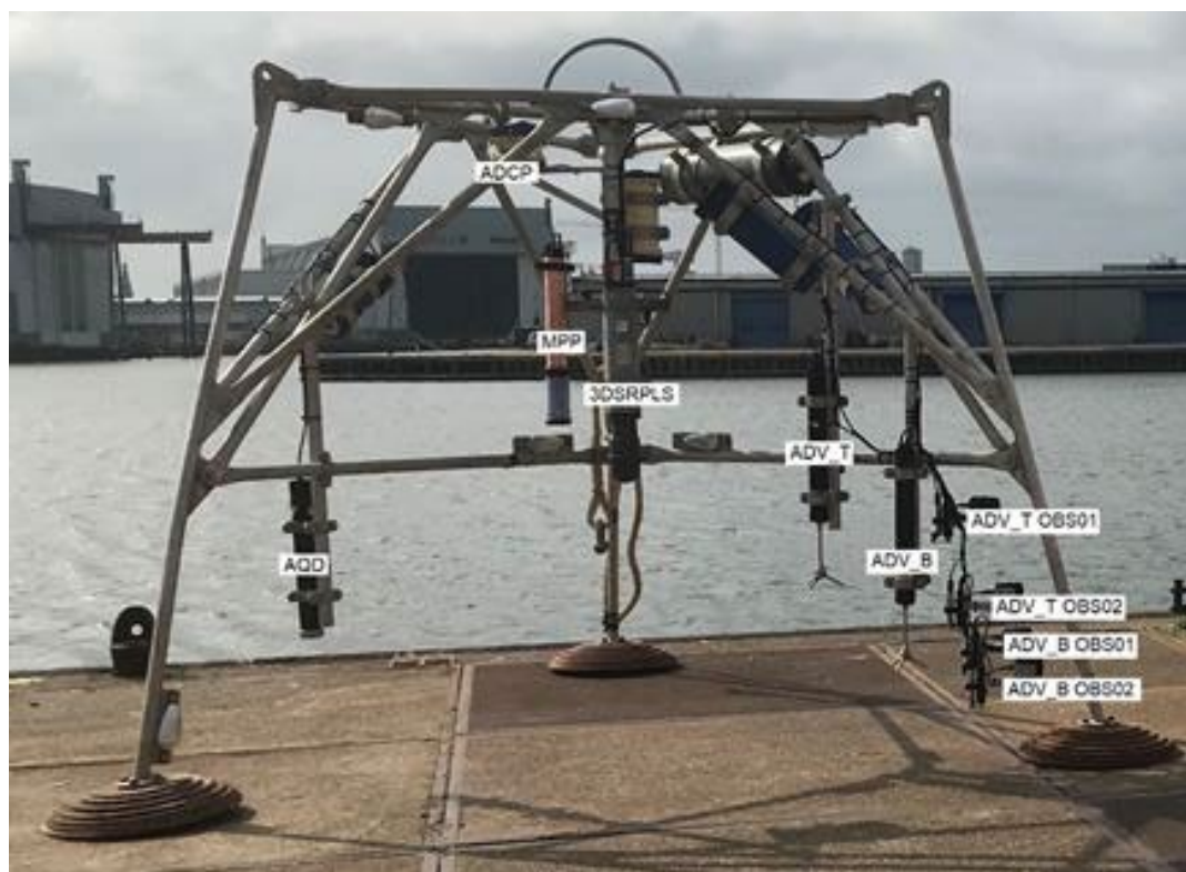
Figuur 2-9: Kustgenese 2 frame, figuur afkomstig uit Stobbelaar, (2023).
