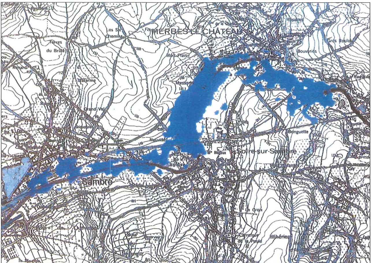
Cartografie van een overstroomde zone van de Samber opgesteld door middel van ruimteteledetectie. (december 1993) (Faculté Universitaire des Sciences agronomiques de Gembloux - Hydraulique agricole - Hydrologie - Télédétection).
