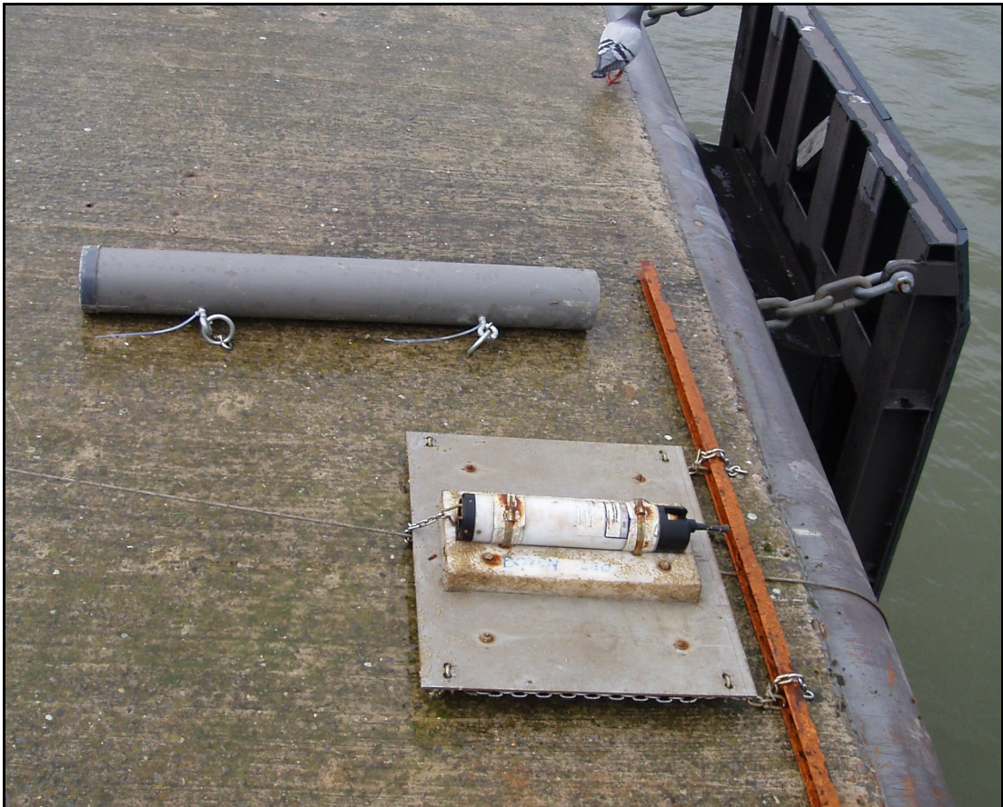
Figuur 2-2 Voorbeeld van bevestigingsplaat meetopstelling en ballastgewicht.
