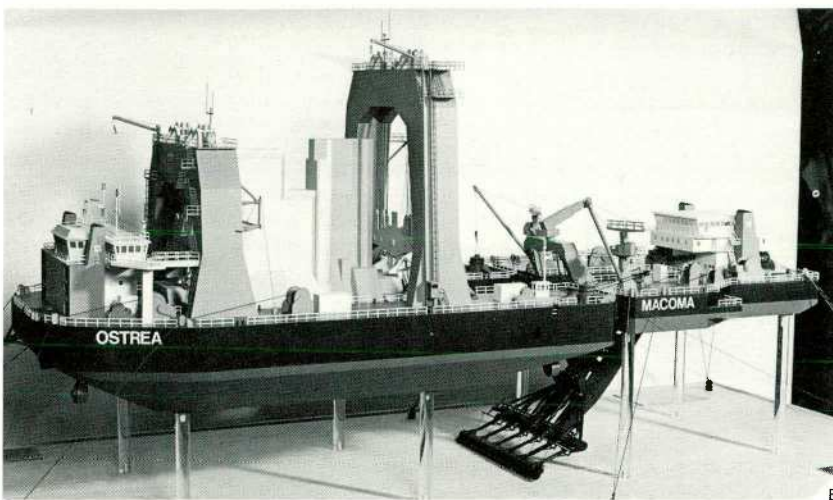
A. Schematische voorstelling van het transporteren en plaatsen van een pijler door de Ostrea B. Vaarroutes van de Ostrea C. De Ostrea onderweg met een pijler D/E. De Ostrea gekoppeld aan de Macoma tijdens een plaatsingsoperatie F. Ondergrouten en ballasten van een pijler
