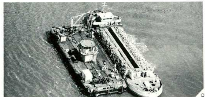
A. Steenopslag op het werkeiland B. Beschermingen van de pijler 1 scherm voor glijstrippen schuiven 2 zeven centimeter dikke extra betondekking 3 vier of zeven centimeter dikke laag spuitbeton 4 tijdelijke afdekking met damwandscherm C. Schematische voorstelling van de toplaagstorter D. Steenstorter Libra Rechts: plaatsen van de zestien pijlers in de stroomgeul Hammen tussen Schouwen en Roggenplaat. Op de voorgrond de cilindervormige betonelementen van de landhoofdconstructie.
