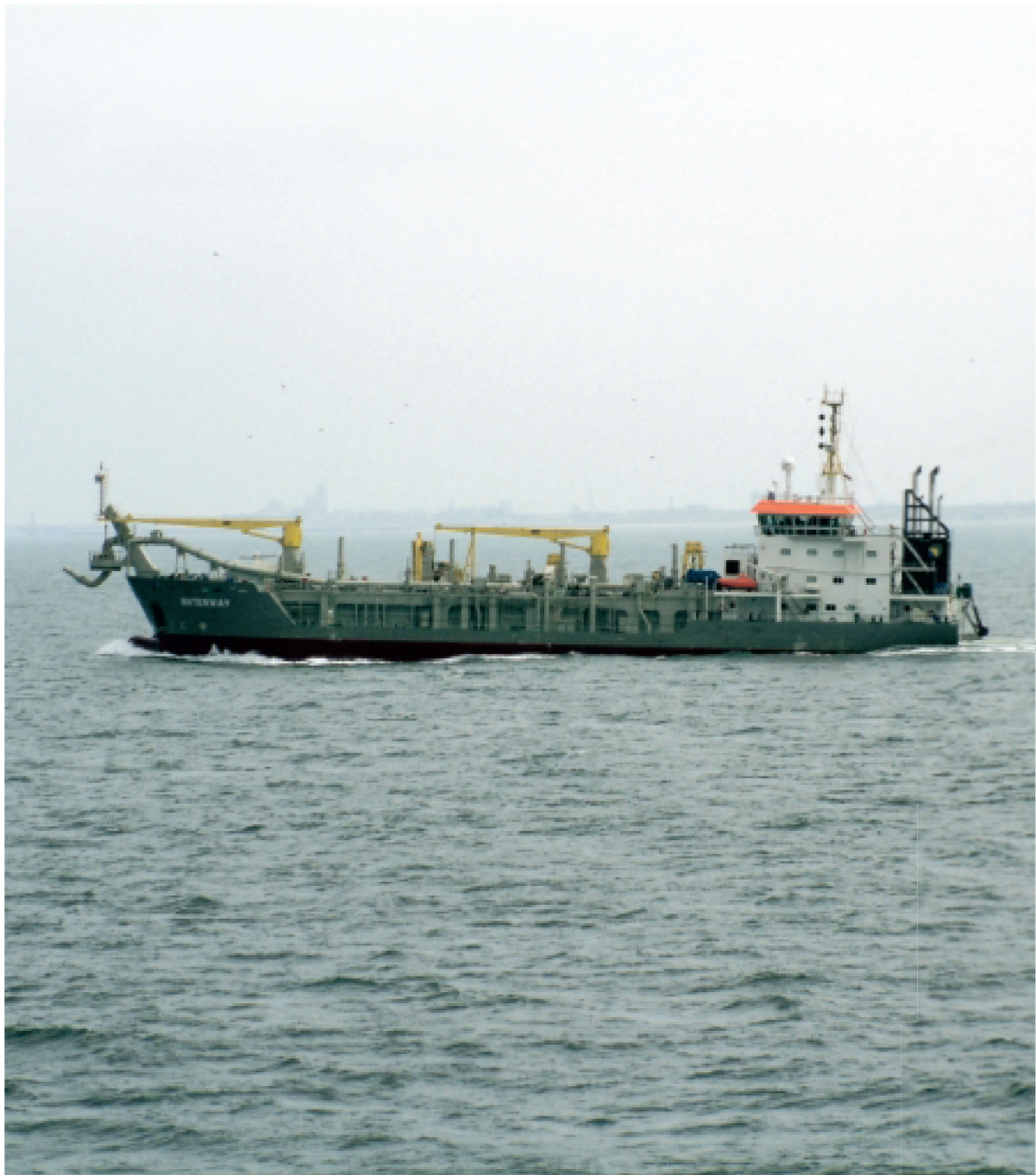
Voor onderwatersuppleties zijn schepen met een beperkte diepgang nodig. Hier de sleephopperzuiger "Waterway". (Foto Directie Noordzee RWS)
