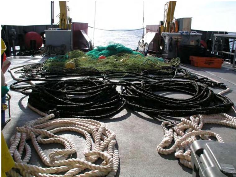
**Abb. 2:** Trawl mit Minihopper-Grundtauvorgeschirr, Gummileinen, Nylonseilen und Aluminium-Scherbrettern an Bord der „Strelasund“.
