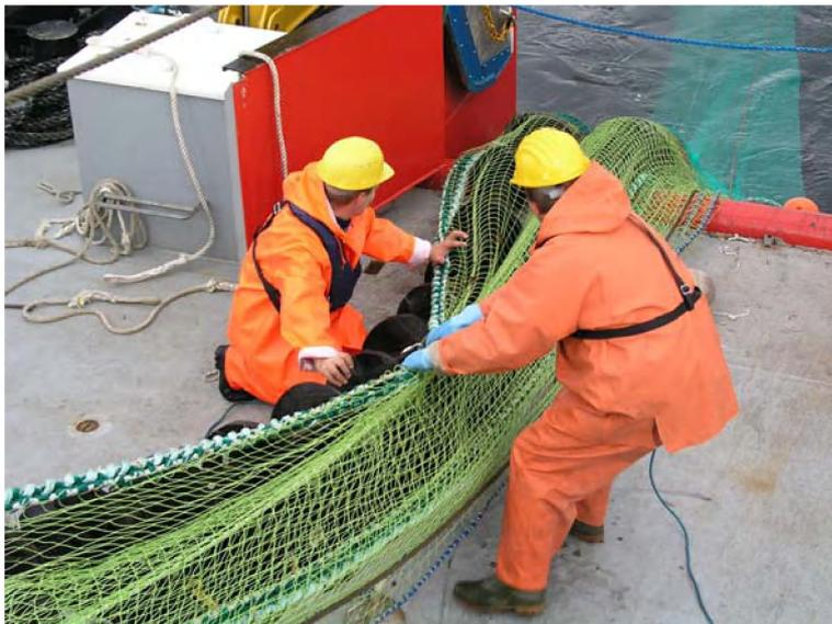
**Abb. 3:** Hieven eines Trawls mit Rockhopper-Grundtauvorgeschirr an Bord von GÖS „Strelasund“.
