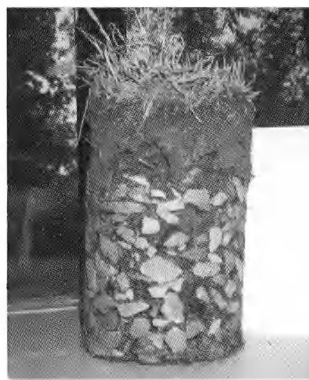
Foto 3. — Doorsnede van de combinatie geotextiel/gevezelde open steenasfalt/teelaarde/begroening.
