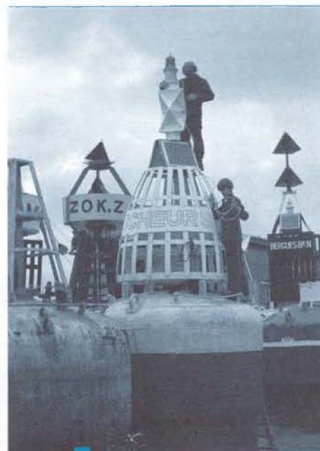
DV Boeien zijn er in vele maten en gewichten. Eens op zee zijn ze onmisbaar als wegmarkeringen en waarschuwingssignalen
