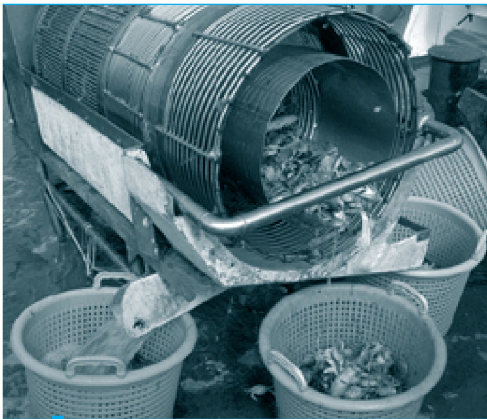
Spoel- en zeefmachine voor het sorteren van de vangsten. De ondermaatse garnaal komt links uit de machine, de grote bijvangst vooraan, en de bovenmaatse garnaal rechts
