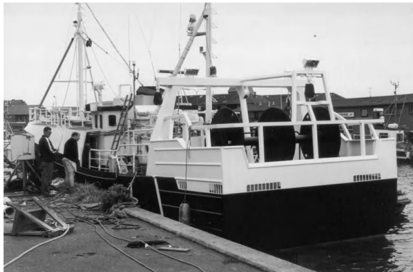
Het achterschip van een bestaande staandwantkotter wordt in het Deense Hvide Sande omgebouwd om te kunnen twinriggen.
