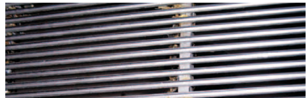
Abb. 5: Ablaufgitter des Wasserabscheiders - Dewatering grid of the water separator.
