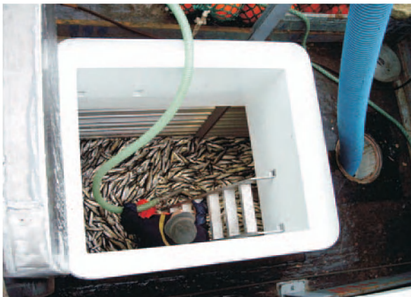
Abb. 3: Saugschlauch und Wasserrückführung im Fischraum des Fangschiffes - Suction line and return water hose in the fish hold of the cutter.
