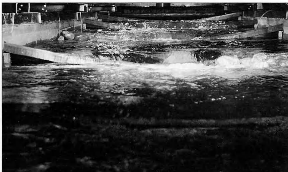
Foto 2: Vistrap in werking bij Q = 0,5 \text{ m}^3/\text{s} .
