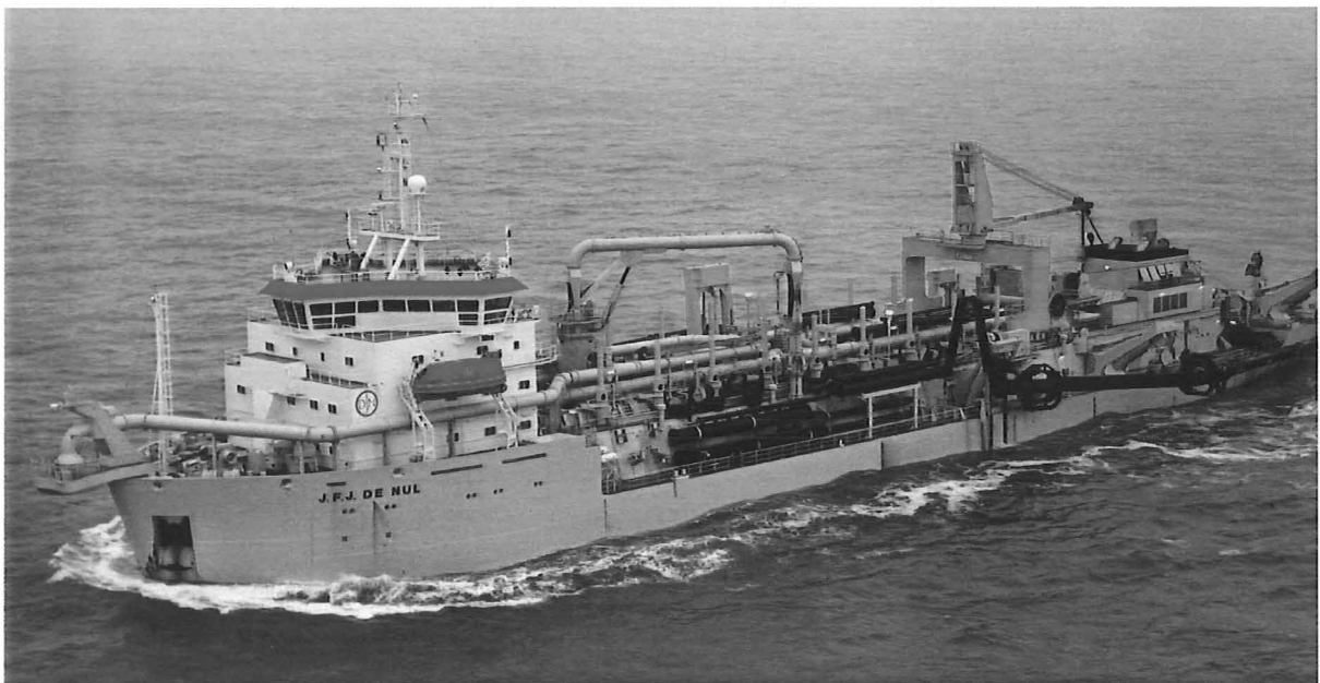
Foto 1: sleeppopperzuiger in actie op de Westerschelde (foto NV Guido Coolens)
