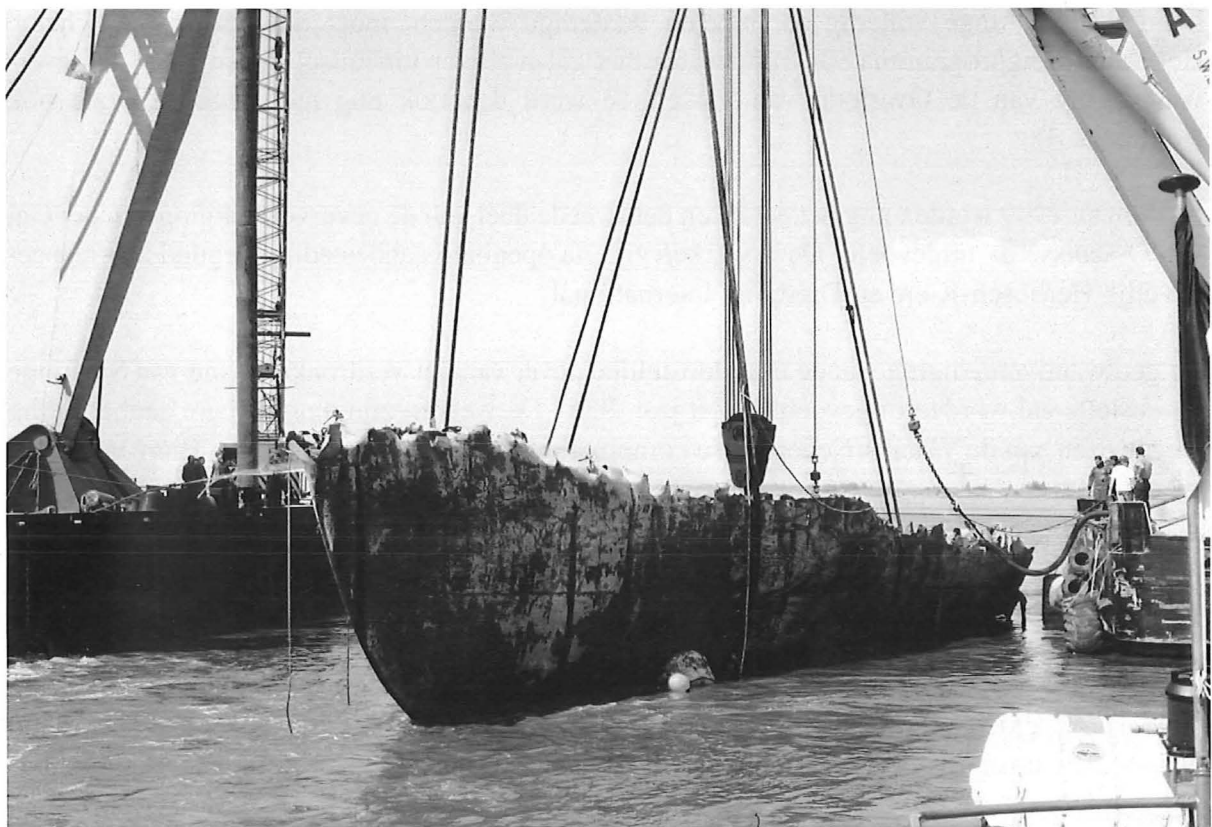
Foto 4: berging van het wrak m.s. Paranagua. Bovenhalen van het onderste deel van de voorsteven.
