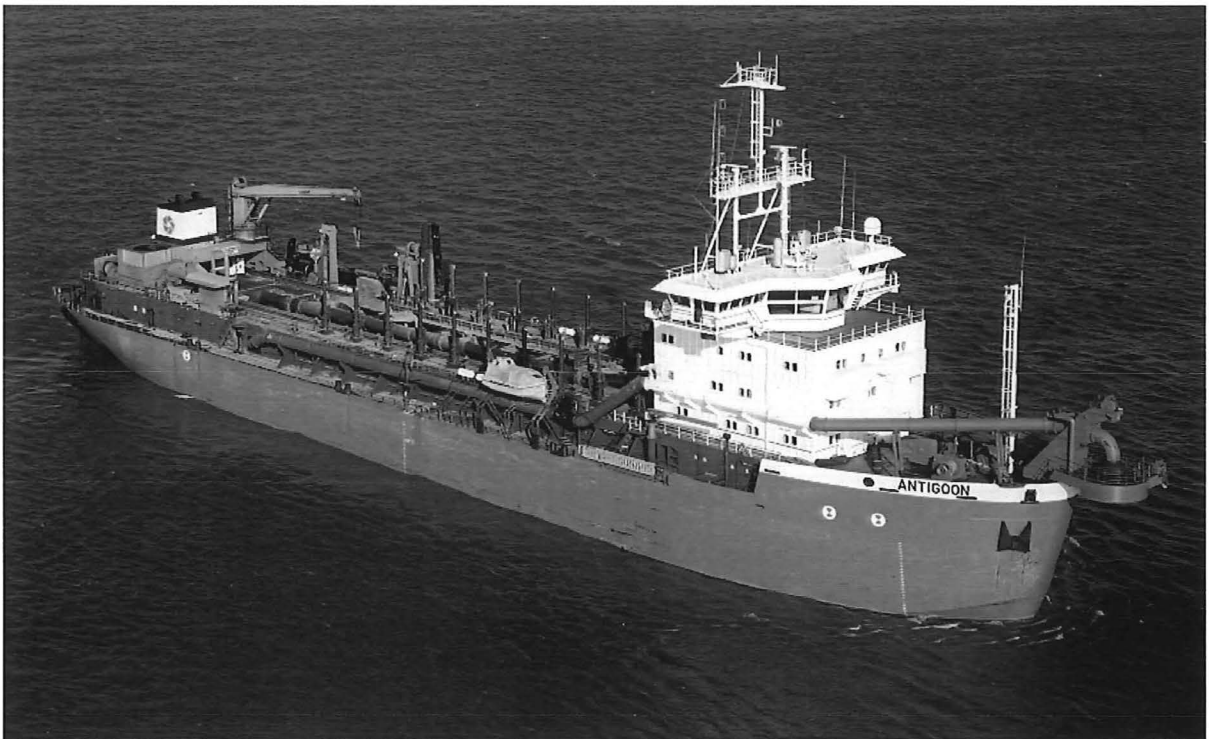
Foto 7: een slephopperzuiger met oppersinrichting op de boeg (foto NV Guido Coolens)
