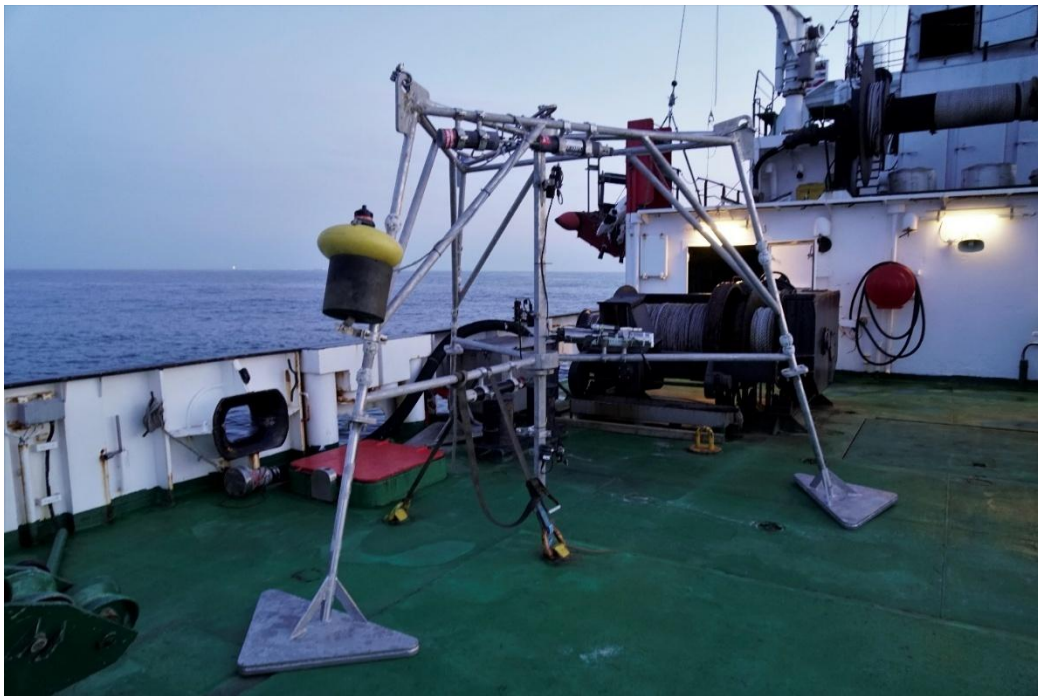
Foto 2. Tripode voorzien van Nortek ADP, SBE19plus, 3 OBS-3+ sensoren, een LISST-200X en pop-up boei
