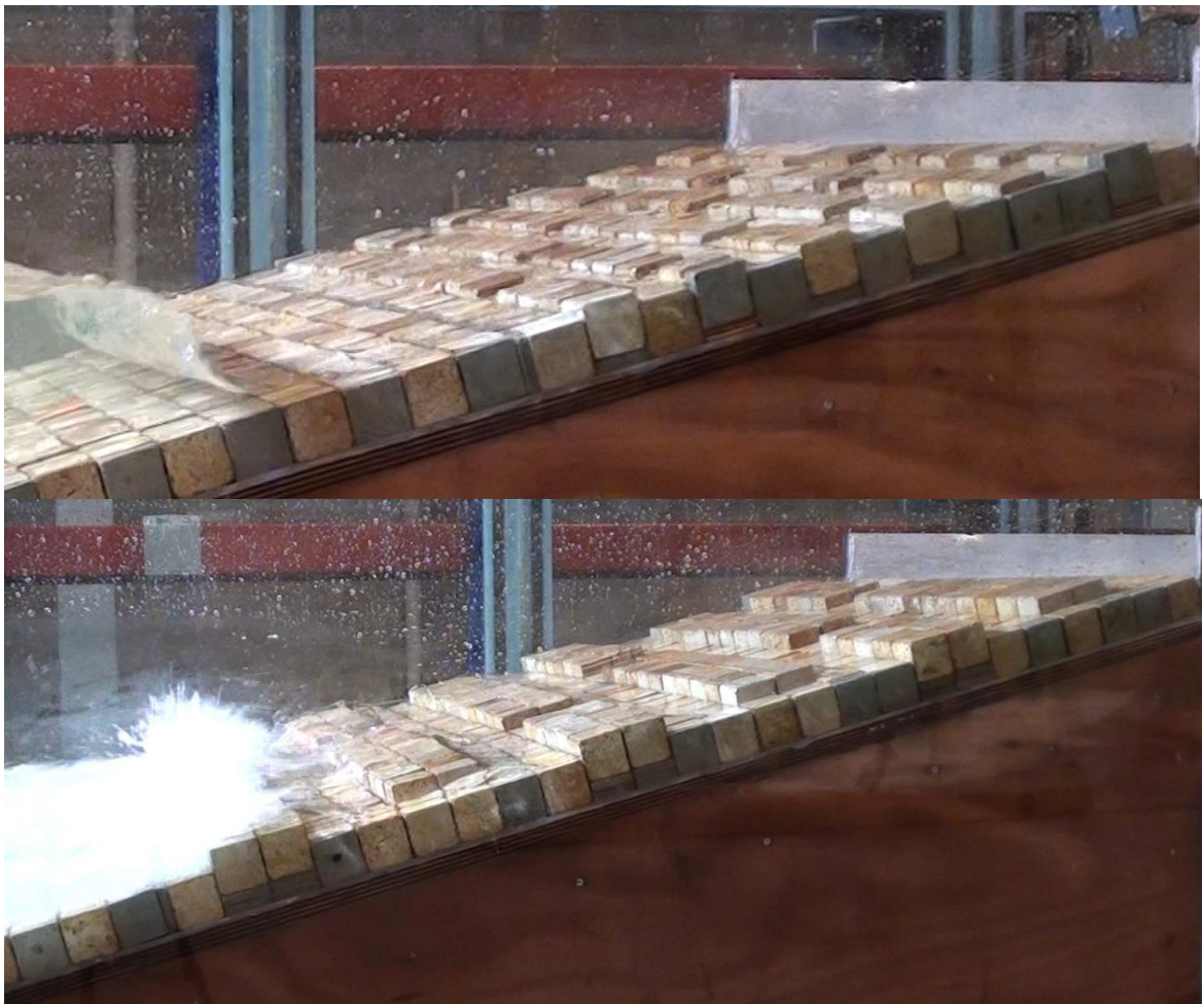
Figuur 2.4: Proevenserie ribbenpatroon schaal 1:22 (boven) en schaal 1:11 (onder)
