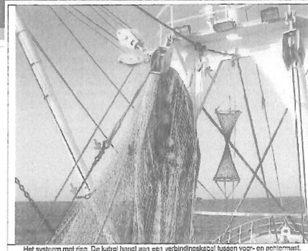
Het systeem met ring. De kuil hangt aan een verbindingskabel tussen voor- en achtermast.
