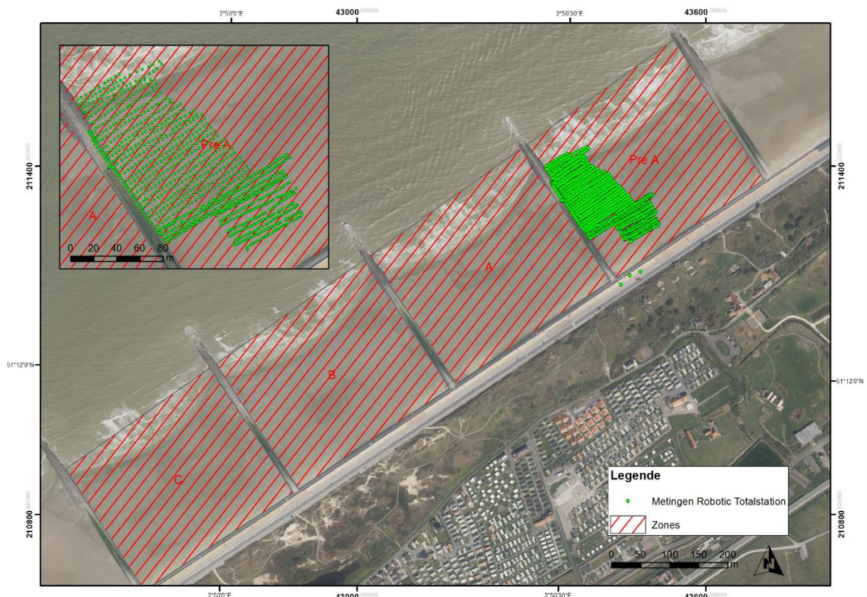
Figuur 2: Overzicht metingen met Robotic Totalstation
