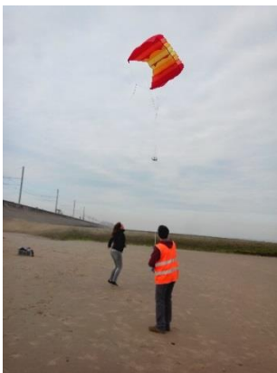
Figuur 7: Gebruik van het kite systeem om aan luchtfotogrammetrie te doen op basis van foto's.
