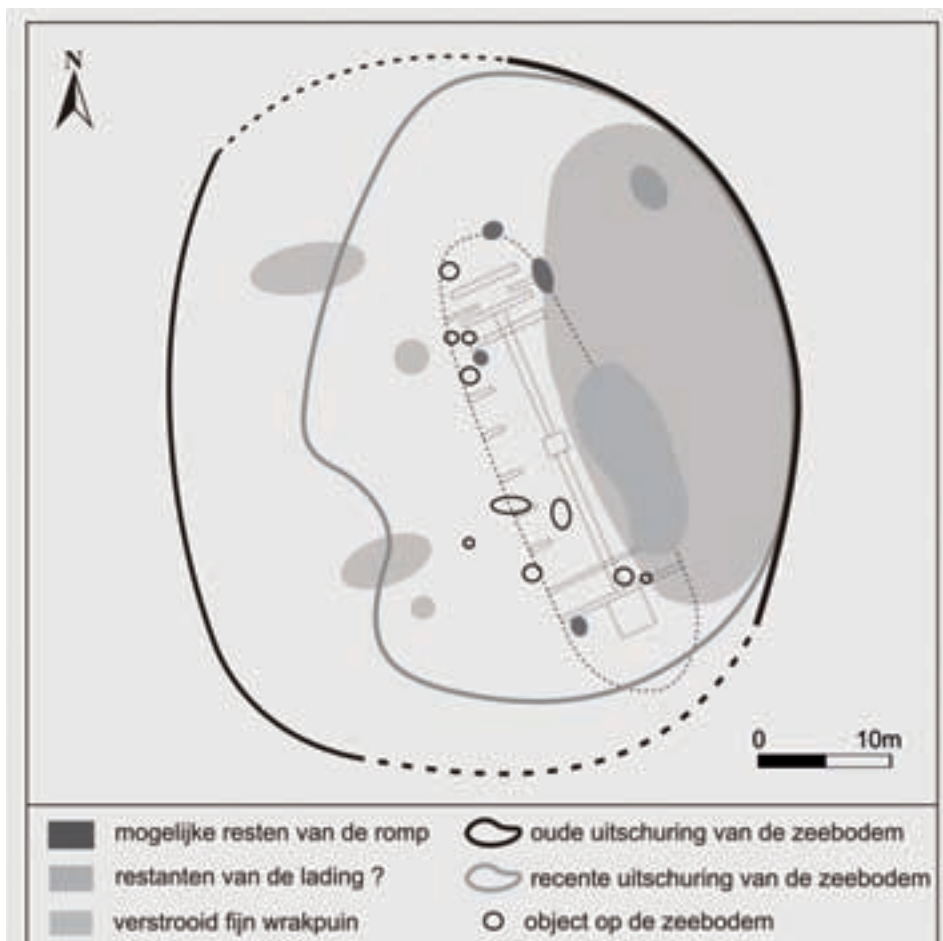
■ Samengestelde interpretatiekaart van de wraksite gebaseerd op de seismische data, met de verspreiding van wrakrestanten en uitgeschuurde zones (TM, RCMG). De fijne stippellijn markeert de gereconstrueerde aflijning van het schip, gebaseerd op voorgaande opgravingen (3H Consulting Ltd. 2005)
